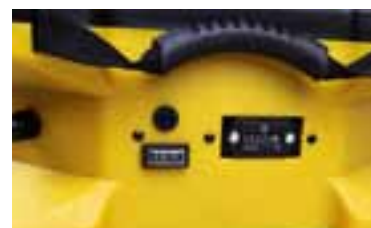
Ovládací panel CDX 20, počítadlo motohodin
