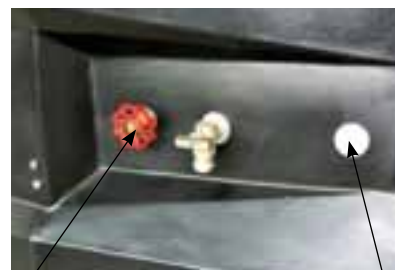
REGULACE PRŮTOKU VODY
