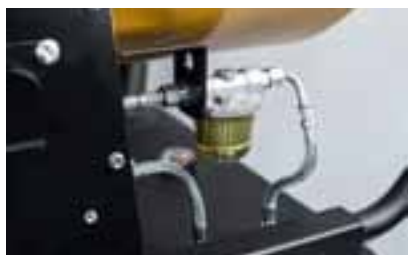
Předehříváč paliva na objednávku, palivový filtr venku.
